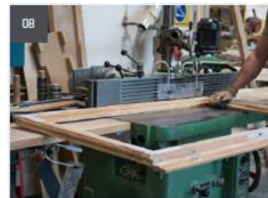
08 Einfräsen der Dichtung am Innenflügel
